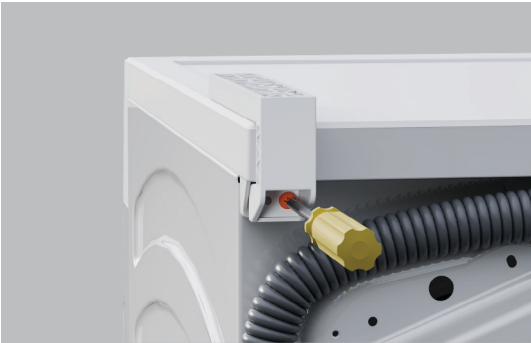
3. 使用螺丝刀或电钻(设置为最低扭矩)将支架拧紧到位。⚠警告:未拧紧螺丝可能会造成倾倒隐患。
